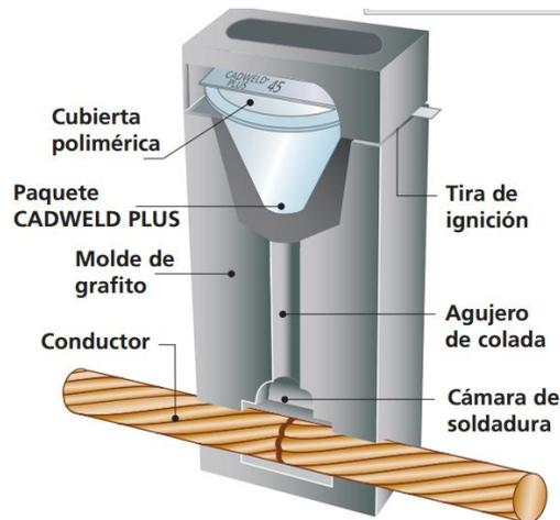
El paquete de materiales de soldadura integrado e inviolable consta de un contenedor de acero que contiene aleaciones de materiales de soldadura patentadas de CADWELD, así como una fuente de ignición. Una vez colocado en el molde CADWELD, el material de soldadura es encendido electrónicamente utilizando una sencilla unidad de control alimentada con pilas desde una distancia de 1,8 metros.
