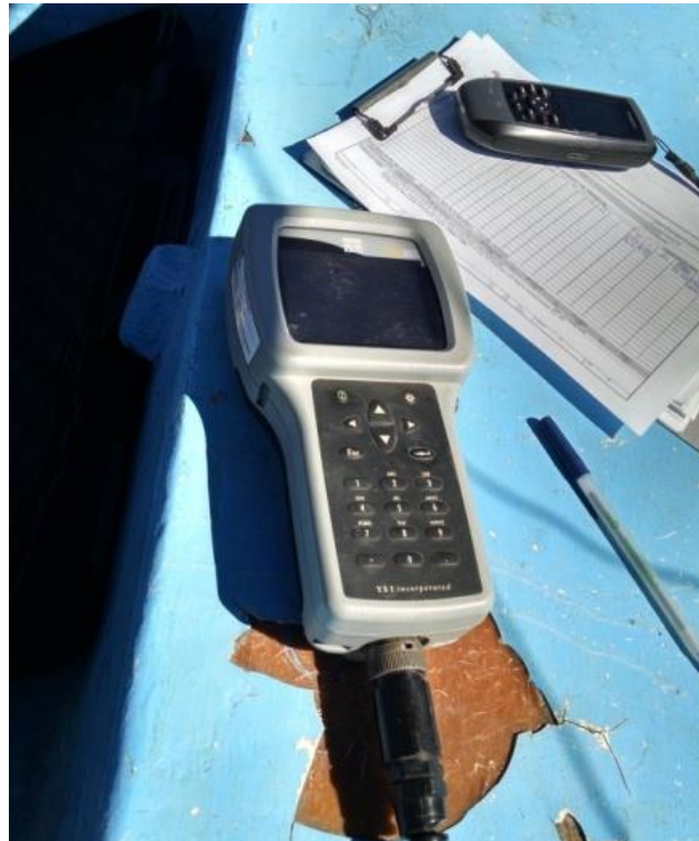
Figura 10. Equipo multiparámetro YSI para la medición de parámetros de campo
