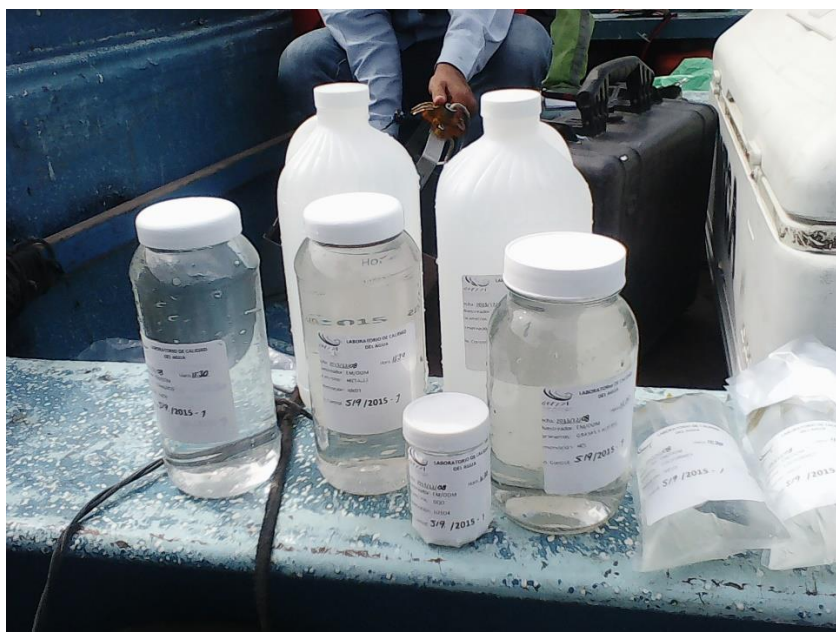
Figura 8. Muestras de agua puntuales para la determinación de parámetros fisicoquímicos, microbiológicos y absorción atómica.
