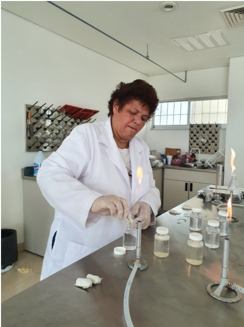
Figura 6. Reactivo utilizado en las muestras el cual es diluido agitando el frasco, para determinar CT y CF en el área de estudio.
