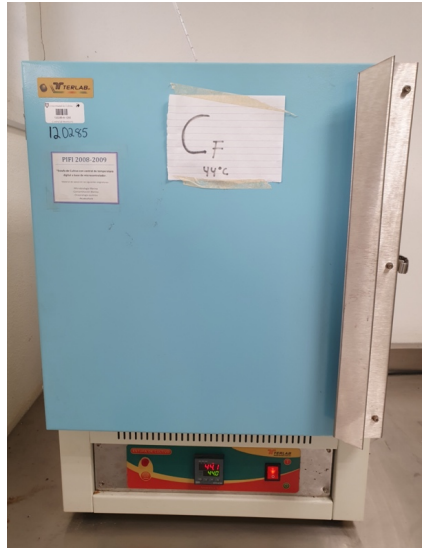
Figura 10. Charolas con muestras de agua incubadas en la estufa para determinar coliformes totales a 35 °C (superior) y coliformes fecales a 44 °C (inferior).
