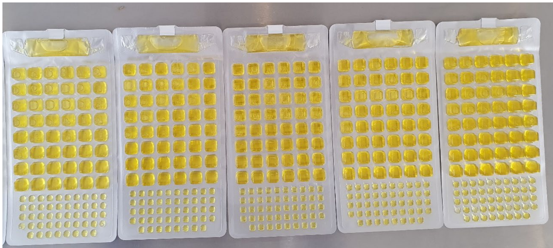
Figura 17. Ejemplos del crecimiento microbiológico de los coliformes totales (superior) y coliformes fecales (inferior), después del periodo de incubación. El crecimiento se observa en todas las celdas de las charolas.
