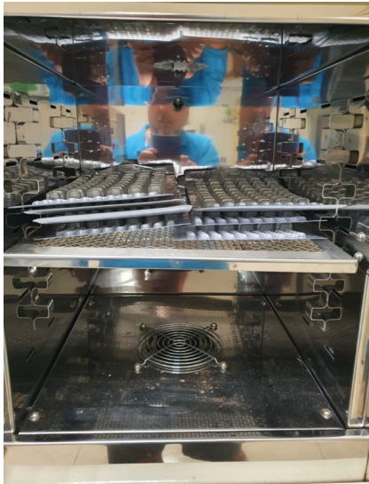
Figura 10. Charolas con muestras de agua incubadas en la estufa para determinar coliformes totales a 35 °C (superior) y coliformes fecales a 44 °C (inferior).
