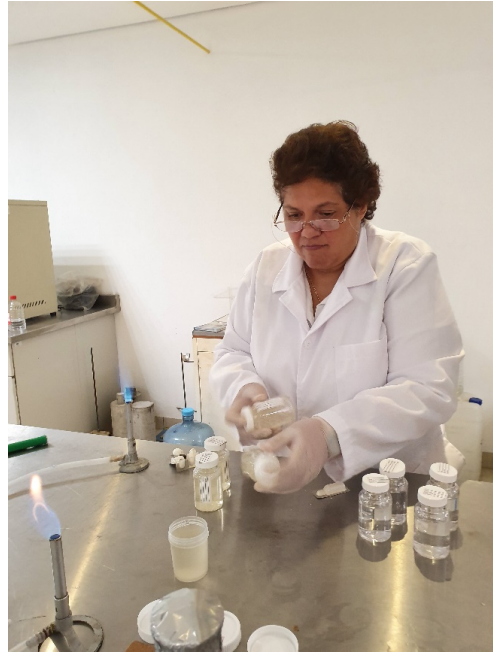
Figura 6. Reactivo utilizado en las muestras el cual es diluido agitando el frasco, para determinar CT y CF en el área de estudio.
