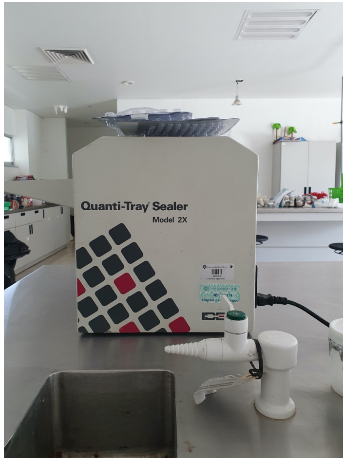
Figura 8. Selladora térmica Quanti-Tray marca IDEXX.
