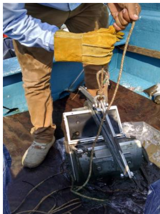
Figura 10. Equipo para muestreo de sedimentos (draga)
