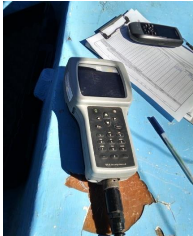
Figura 7. Equipo multiparámetro YSI para la medición de parámetros de campo
