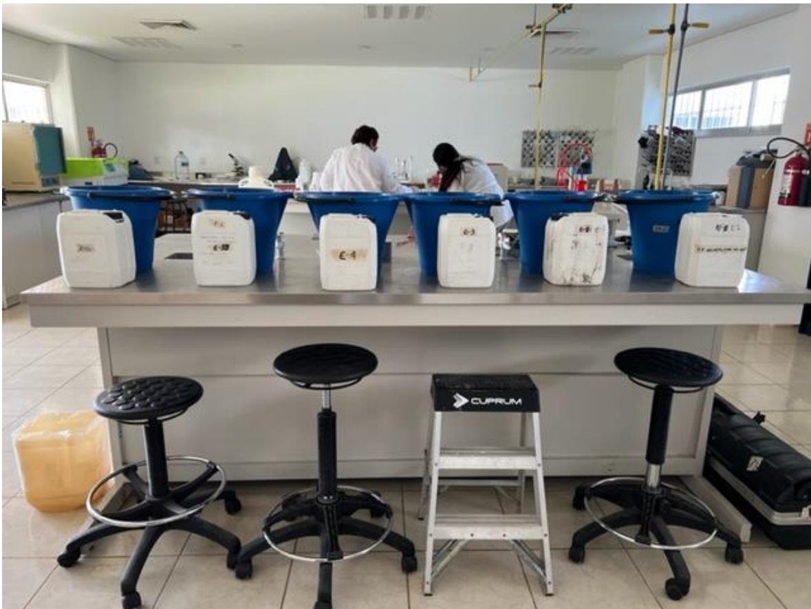
Figura 13. Muestras de agua que fueron colectadas en garrafones de plástico de 5 L.
