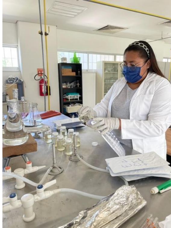
Figura 9. Charolas Quanti-Tray en donde se coloca la muestra sembrada con el reactivo.
