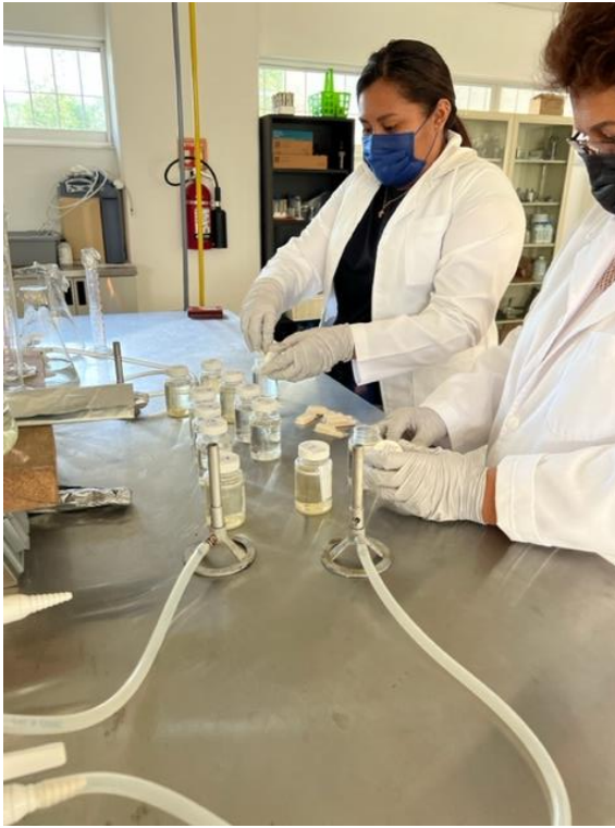
Figura 7. Dilución del reactivo Colilert-18 en la muestra de agua en frascos con agua esterilizada.
