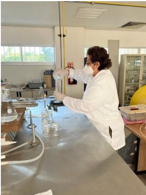
Figura 6. Frascos estériles con agua destilada en los que se diluye el volumen de muestra.
