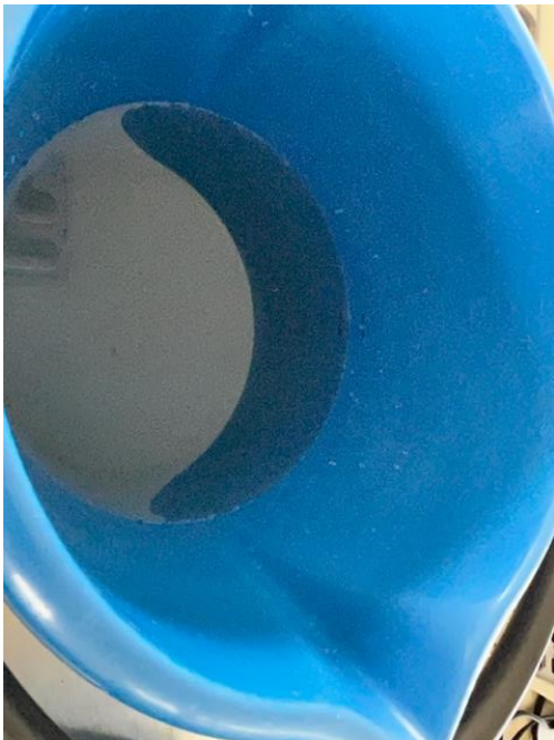
Figura 14. Cubetas de plástico en las que se vierte el agua de la muestra, que se deja sedimentar por más de 3 horas.
