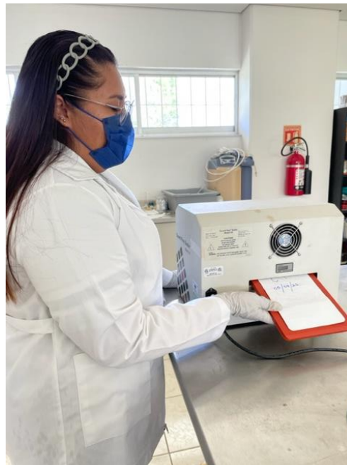
Figura 10. Charolas Quanti-Tray selladas por calor en donde se observa el ingreso de la charola antes de sellar (a) y después la charola sellada (b).
