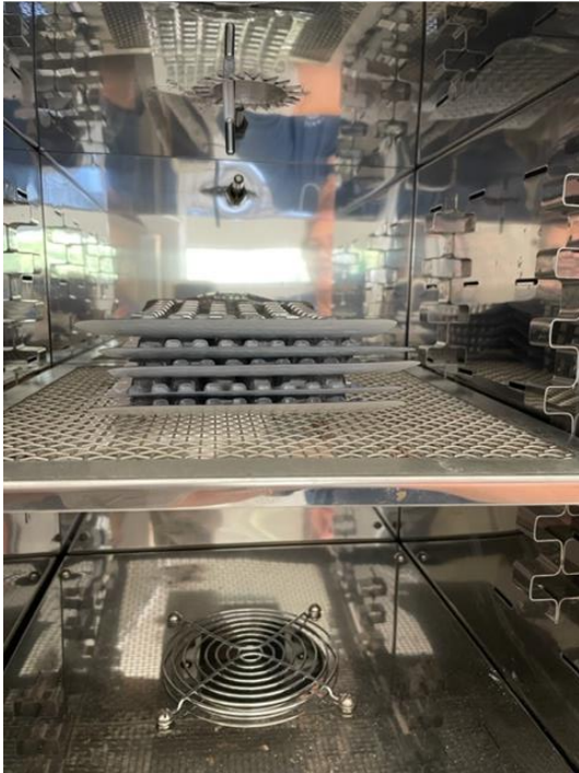
Figura 11. Charolas con muestras de agua incubadas en la estufa para determinar coliformes totales a 35 °C (a) y coliformes fecales a 44 °C (b).
