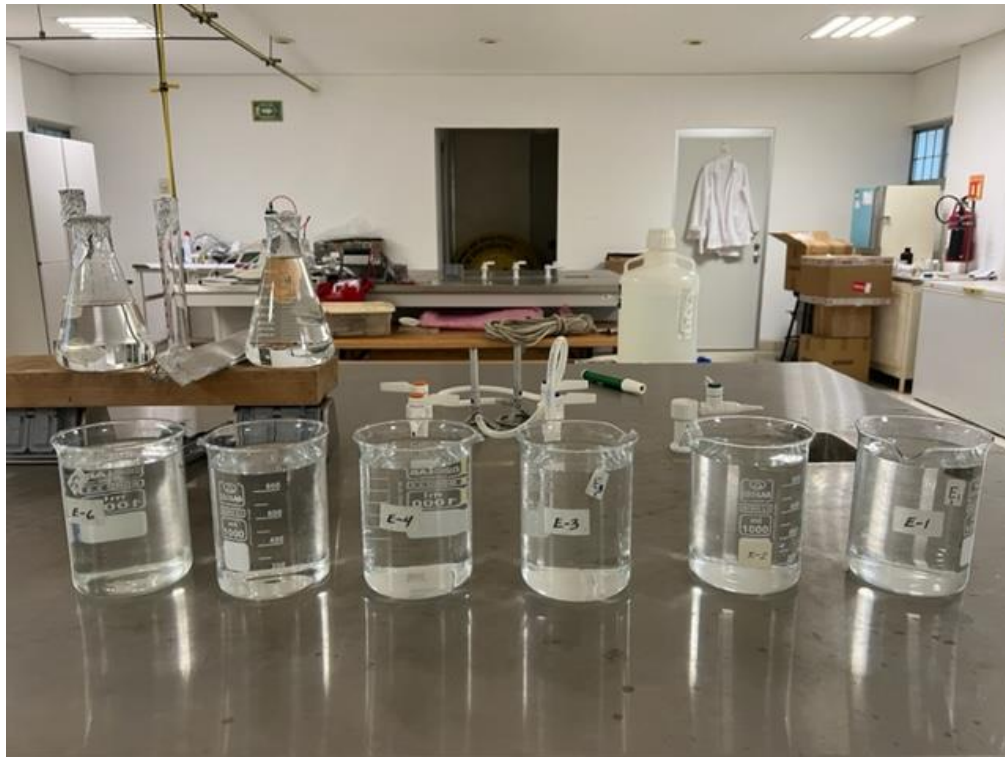
Figura 17. El sobrenadante de las botellas de plástico es diluido en agua destilada, que se deja sedimentar por más de 3 horas.
