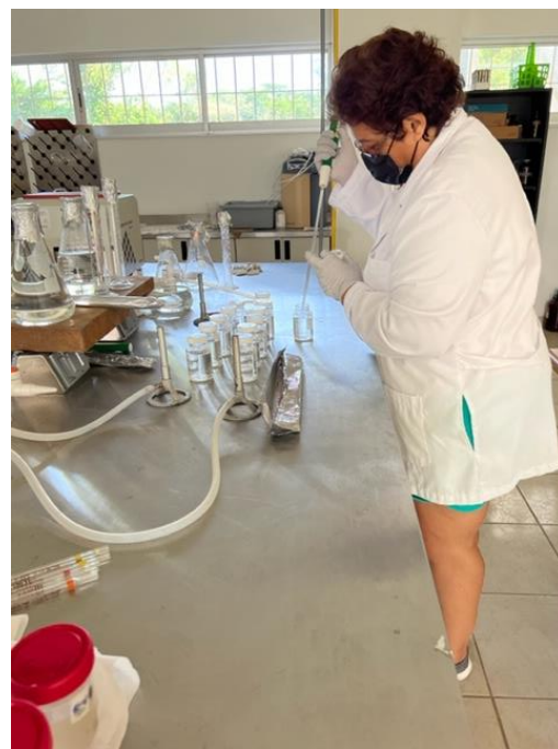
Figura 6. Frascos estériles con agua destilada en los que se diluye el volumen de muestra.
