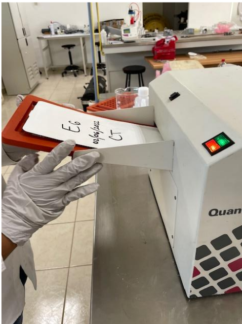
Figura 10. Charolas Quanti-Tray selladas por calor en donde se observa el ingreso de la charola antes de sellar (a) y después la charola sellada (b).
