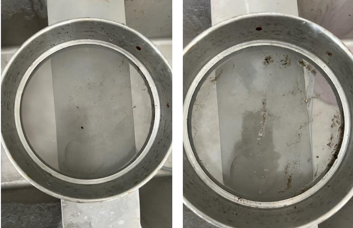
Figura 15. Filtrado de la muestra de agua con el tamiz para retener el sedimento mayor a 170 \mu\text{m} , el cual es eliminado.
