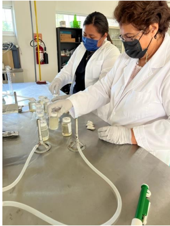
Figura 7. Dilución del reactivo Colilert-18 en la muestra de agua en frascos con agua esterilizada.
