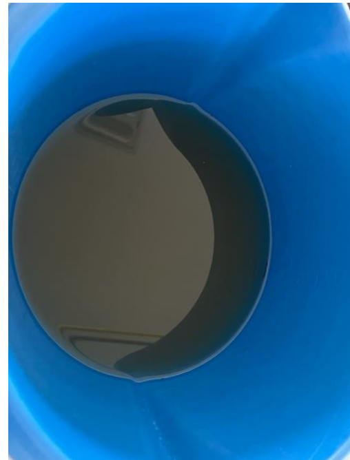
Figura 14. Cubetas de plástico en las que se vierte el agua de la muestra, que se deja sedimentar por más de 3 horas.
