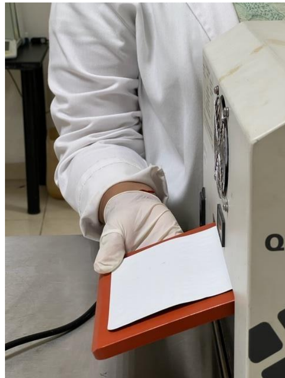
Figura 9. Charolas Quanti-Tray selladas por calor en donde se observa el ingreso de la charola antes de sellar (a) y después la charola sellada (b).
