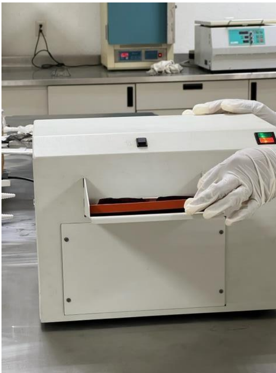
Figura 9. Charolas Quanti-Tray selladas por calor en donde se observa el ingreso de la charola antes de sellar (a) y después la charola sellada (b).
