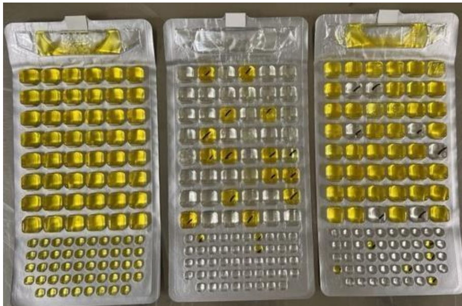
Figura 18. Charolas Quanti-Tray que muestran el crecimiento de bacterias coliformes totales (superior) y coliformes fecales (inferior) en el PI.
