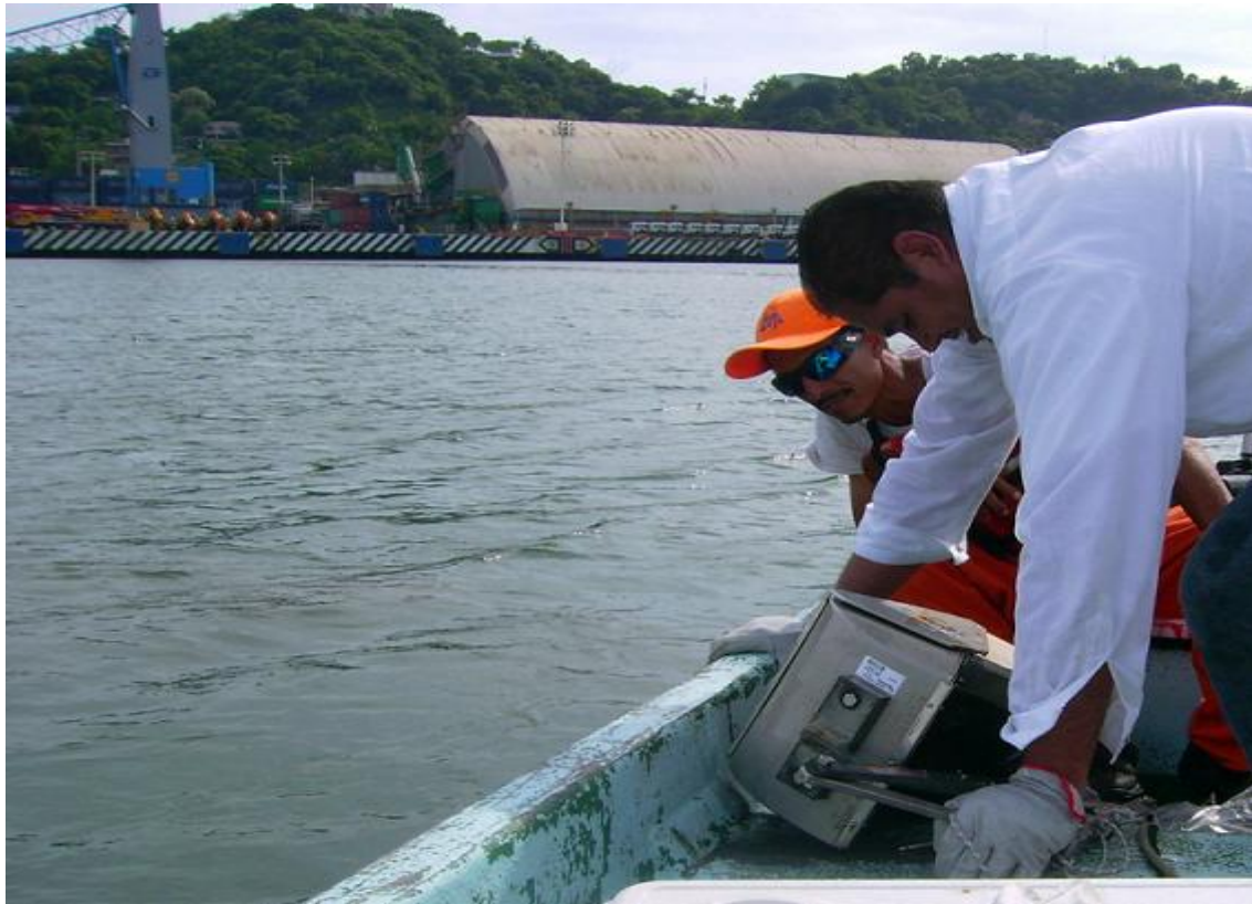
Figura 42. Toma de muestras de sedimento en las Bandas de San Pedrito.
