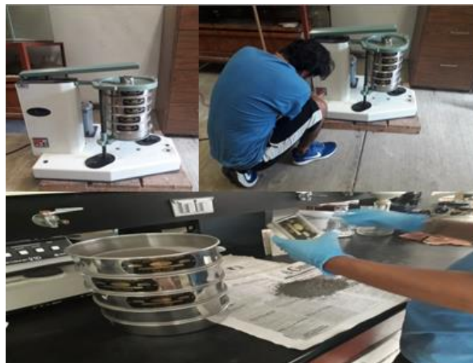
Figura 4. Colocación de la muestra en la tamizadora y pesado del material retenido en los tamices.
