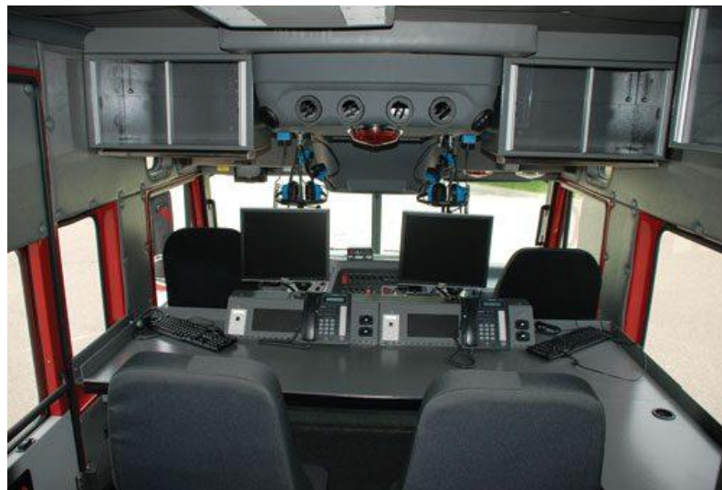
Ejemplo de cabina adaptada para el comando y sistemas de información (cuando no hay módulo trasero).
