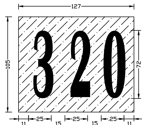
ROTULACION DE ESCALA EN LOSAS DE MUELLE
